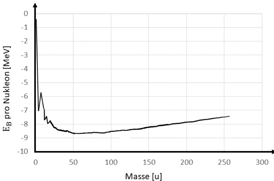
Abbildung 3.4: Kernbindungsenergie pro Nukleon als Funktion der Massenzahl
